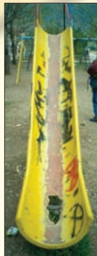
Εικ. 9: Επικίνδυνη φθορά (οπές), έλλειψη συντήρησης - παρακολούθησης
