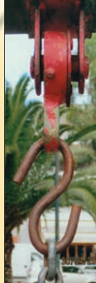
Εικ. 6: Ανύψωση λήπανα (ελατόγραμμα απαγορεύεται) - ανοικτοί γάντζοι ανάρτησης (επικίνδυνο)
